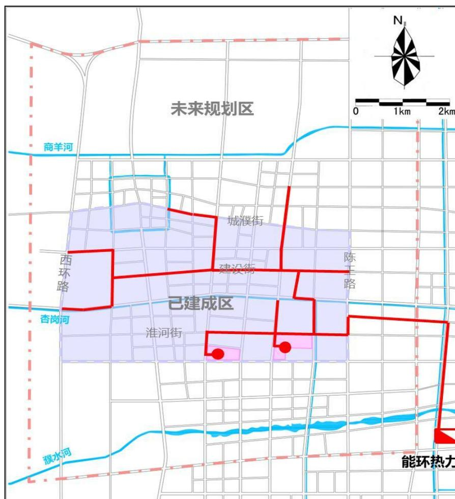
图 4-3 已有供暖管网平面布置图
